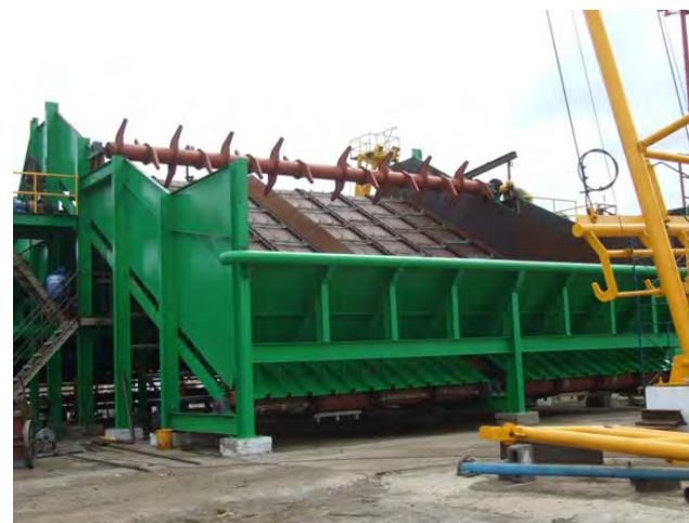
Instalación de Mesa Receptora de Caña con Sistema de Limpieza en Seco
