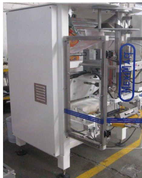
Prototipo de máquina embolsadora vertical para bolsa Doypack
