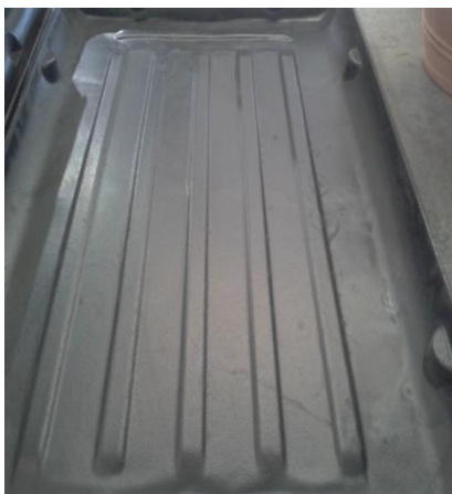
Prototipo de Contenedor para Diesel, resistente a la intemperie y capaz de recibir líquidos hasta 60 C.
