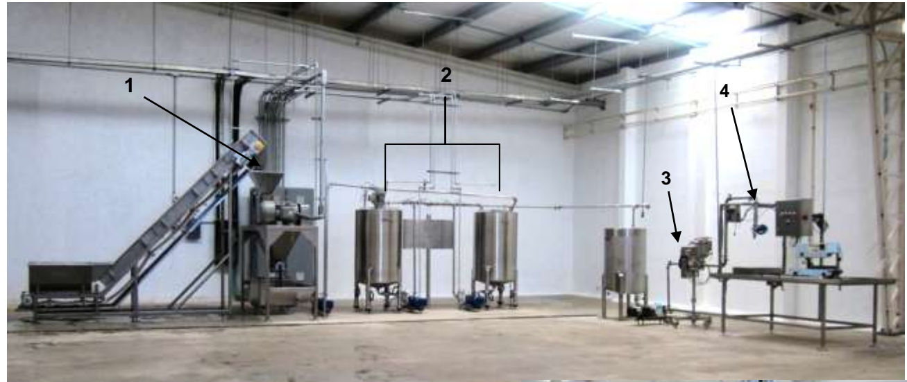
Etapas del proceso de la planta piloto .1) Molienda;2) Mezclado / Formulación; 3) Detección y separación de partículas metálicas; 4) Envasado;5) Tratamiento térmico.
