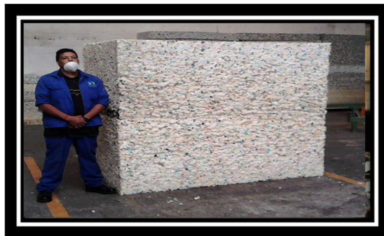
Producto final del proceso: Block de material reciclado de espuma conocido en el mercado como “Aglutinado de Espuma de Poliuretano”
