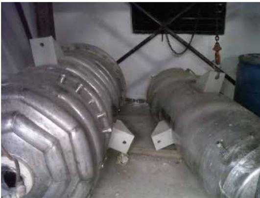
Recepción de los tanques hechos en México para ser acondicionados como fermentador piloto y tanque de recargas.
