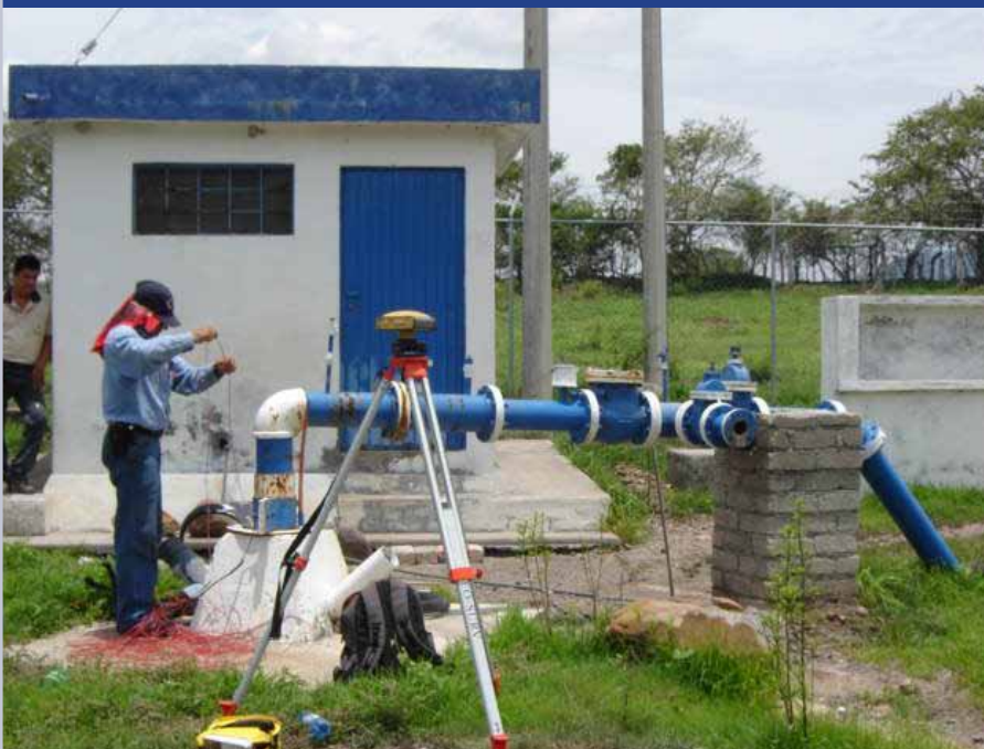
Figura 4. Medición del nivel del agua subterránea durante las campañas de campo
