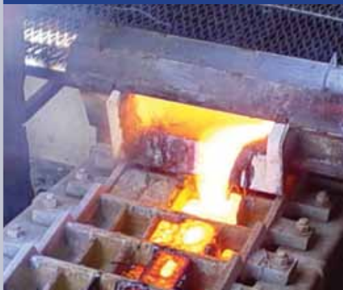
Figura 4a. Colado por gravedad en moldes metálicos
