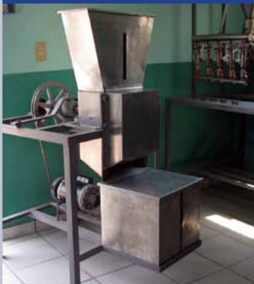
Figura 3. Prototipo de molino de hojas de gobernadora
