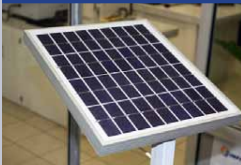
Figura 10. Panel solar adaptado al reactor solar para la producción de biodiesel
