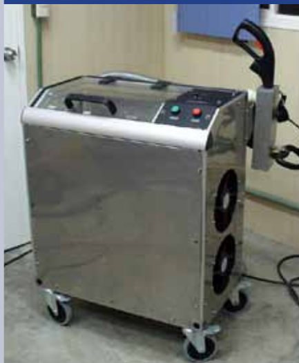
Figura 3. Vista general de un prototipo de láser de limpieza. Incluye uno de los sistemas de enfriamiento desarrollados en este proyecto
