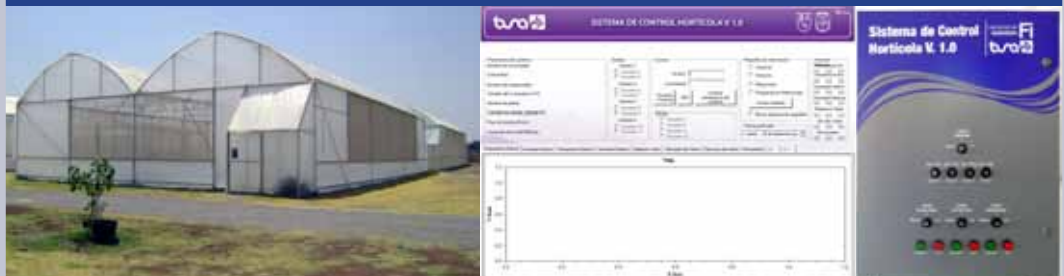
Figura 1. Sistema de automatización para horticultura TUNA® V1.0: invernadero, pantalla del software y panel de potencia
