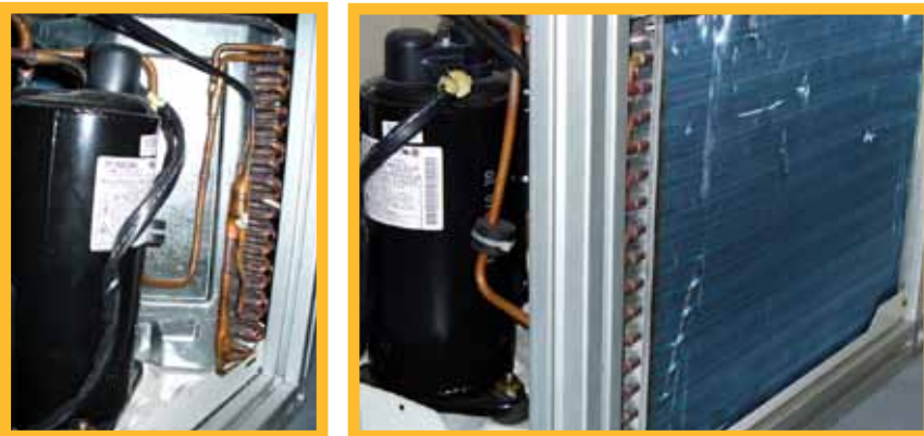
Figura 2. El prototipo de sistema de enfriamiento construido con base en compresor de refrigeración. Dimensiones 50x70x60cm, peso: 45kg, capacidad de enfriamiento: 2900 Watts. Consumo eléctrico: 5.2A, 230VAC
