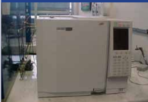
Figura 5. Cromatógrafo de gases para determinar la calidad del diesel y biodiesel
