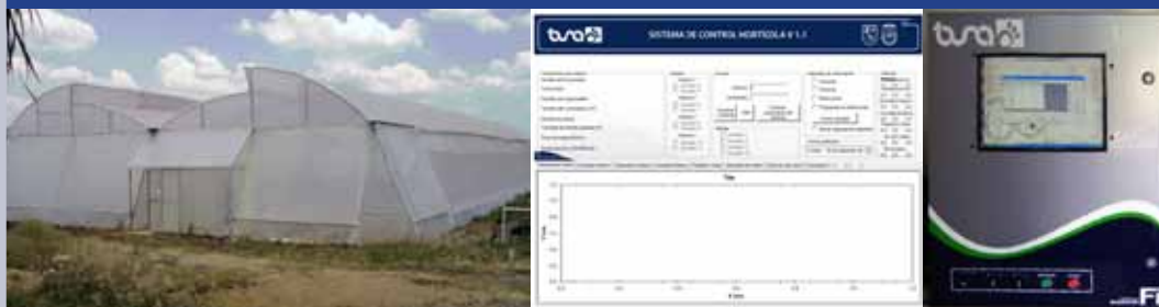
Figura 2. Sistema de automatización para horticultura TUNA® V1.1: invernadero, pantalla del software y panel de potencia
