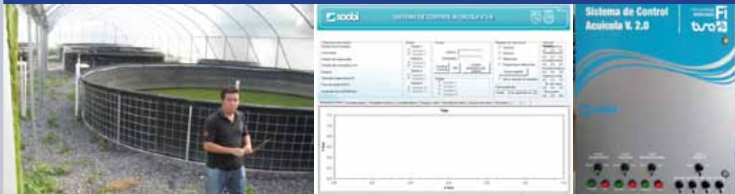
Figura 4. Sistema de automatización para acuicultura TUNA® V2.0: invernadero, pantalla del software y panel de potencia
