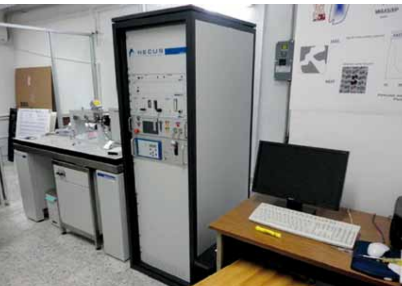
Equipo de dispersión de rayos X de ángulo amplio y de ángulo bajo.
