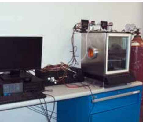
Sistema de cámara de generación de humedad por método de flujo dividido, desarrollo tecnológico creado por CIDESI.
