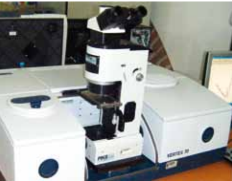
Espectrómetro Infrarrojo (FTIR) utilizado en la medición de propiedades de estructura de los materiales de trabajo, así como en piezas terminadas de Talavera.
