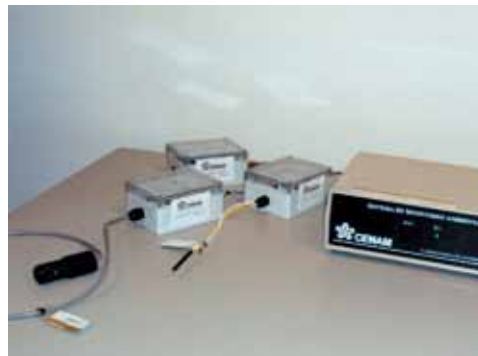
Sistema de Monitoreo Ambiental, desarrollo tecnológico creado por el CENAM colocado en cada una de las magnitudes Instrumentadas.
