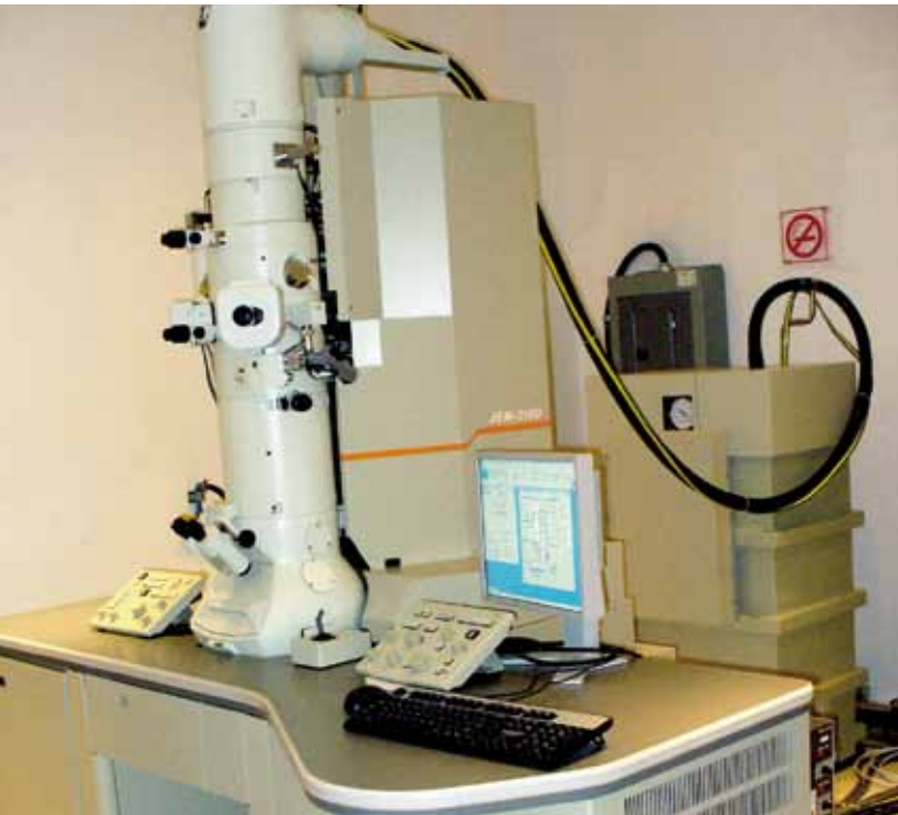
Microscopio electrónico de transmisión de 200 KV Jeol 2100.
