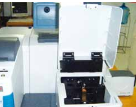
Espectrómetro Raman utilizado en la medición de propiedades de estructura de los materiales de trabajo, así como en piezas terminadas de Talavera.
