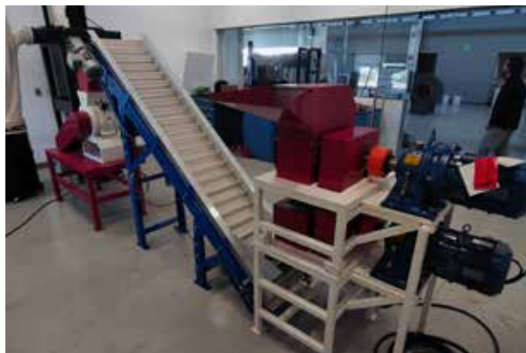
Línea de reciclaje integrada con los sistemas de molienda, transferencia y separación de polvo, la línea se encuentra completamente operativa y funcional. Proyecto MADTEC-2025-M-312, apoyado por la SECIHTI.
