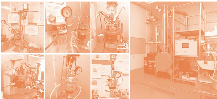
**Nota:** desarrollo de tecnología para el procesamiento de sargazo para la producción de compuestos de interés industrial y biocombustibles a nivel laboratorio y piloto desarrollado por el grupo de biorrefinería de la Universidad Autónoma de Coahuila.
