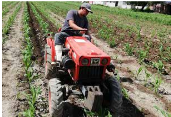
Imagen: cultivadora de dos surcos para el control de arvenses. Foto: José Luis Campos Mariscal.
