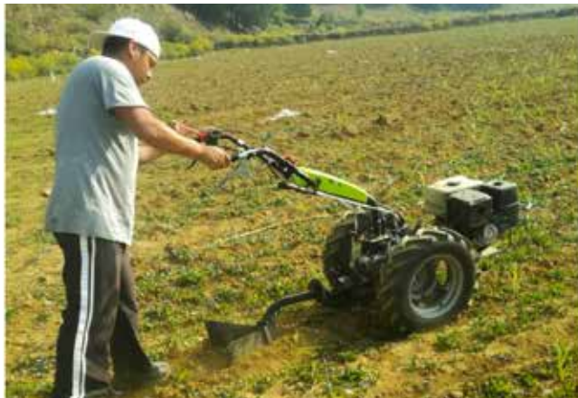
Imagen: Realización de escarda con motocultor usando el arado como Implemento. Foto: Alfonso Quiroz Ramírez.
