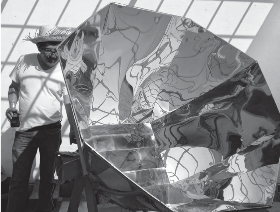
Figura 7. Horno solar de autoconstrucción Tolokatsin 2020
