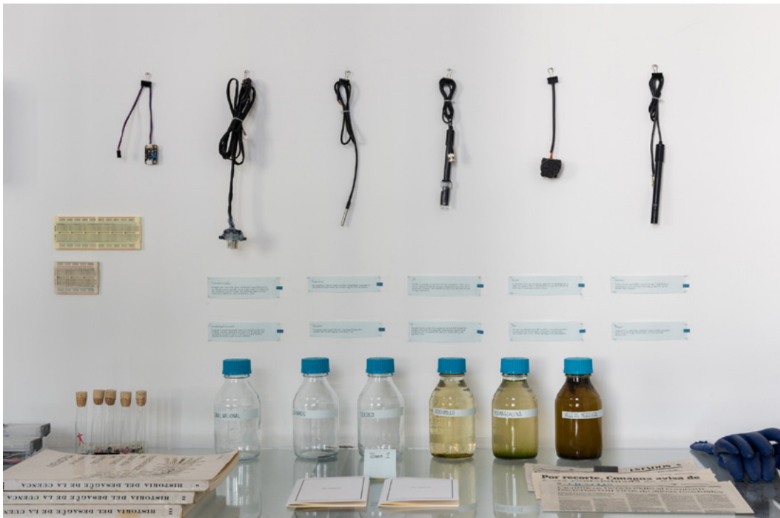
▲ Mesa de exhibición. En el muro hay sensores que miden el oxígeno, la temperatura, el pH, el caudal y la turbiedad del río Becerra. Abajo, muestras de agua y la publicación Ay agüita , bitácora de trabajo del Colectivo. Fotografía de Colectivo Panósmico, 2020.
